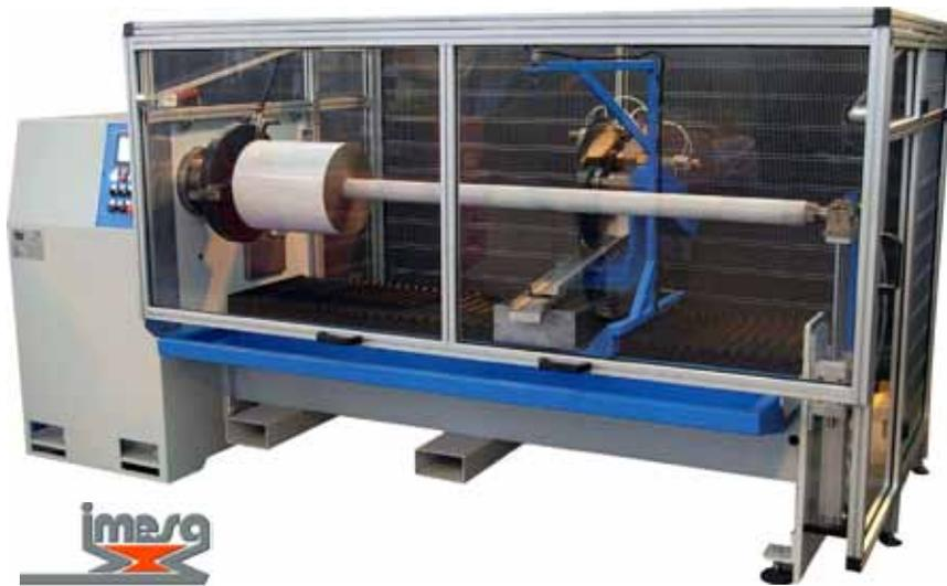
El modelo **Imesa 557** permite cortar materiales sintéticos, revestimientos, tejidos, tejidos recubiertos, materiales engomados y adhesivados, TST, materiales técnicos, láminas de caucho, goma espuma y similares, películas de PVC-PP-PE, grafito, corcho, etc. Se reduce el ajuste manual del operador mediante el uso de dispositivos de control electrónicos. El software es muy flexible y sencillo, permitiendo un considerable ahorro de tiempo y de material.
